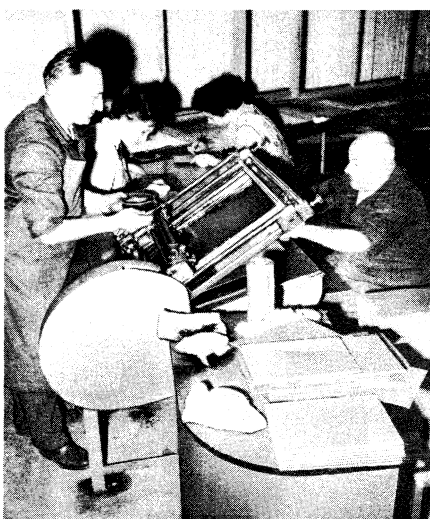
Bild 7. Halbautomatische Siebdruckmaschine im Fuba-Werk Gittelde
