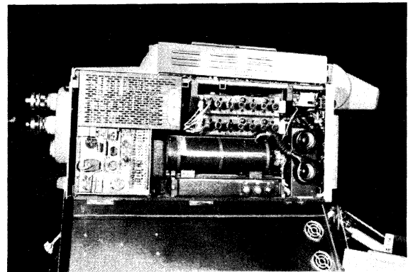
Bild 2. Innenansicht der in Bild 1 gezeigten Farbfernseh-Kamera. Es sind drei Bildaufnahmeröhren vorhanden, deren jede eine Grundfarbe vom vorgeschalteten Prisma-System zugeteilt erhält
