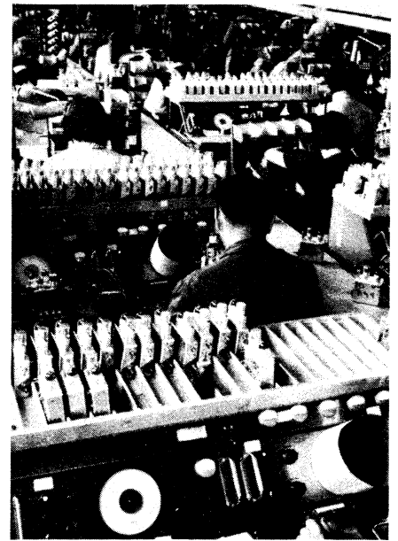
Bild 1. Abgleich von UHF-Tunern auf Klemm-Prüftischen im Fuba-Werk Bad Salzdetfurth. Tagesproduktion: rund 500 Stück
